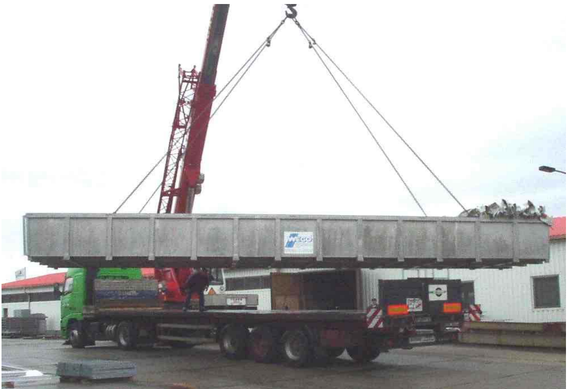
Bild 10 Möglichkeit der Kranung der Leckagewanne
