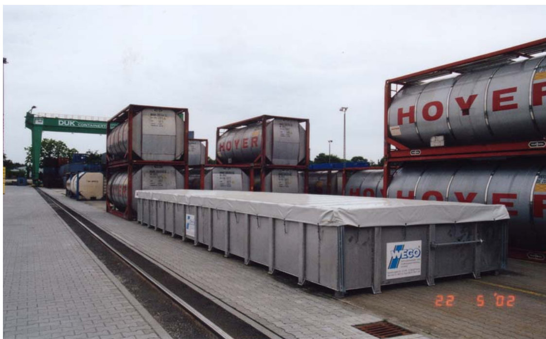
Bild 2 Ausstattung mit Spezial-Schiebeverdeck
