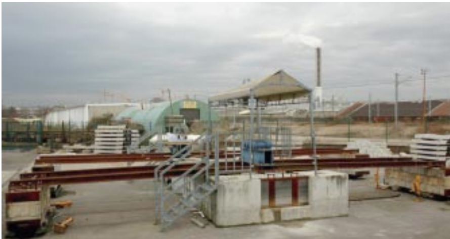
Bild 13: Prüfung der Dauerfestigkeit von Schwellenbesohlungen mit dem Vibrogir-Test bei einer simulierten Belastung von 400 Mio. GBT (Gesamt-Bruttotonnen)
