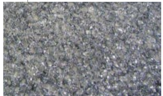
Bild 12: Kunststoffgeflecht als Kontaktmedium für Besohlung von Gleisschwellen
