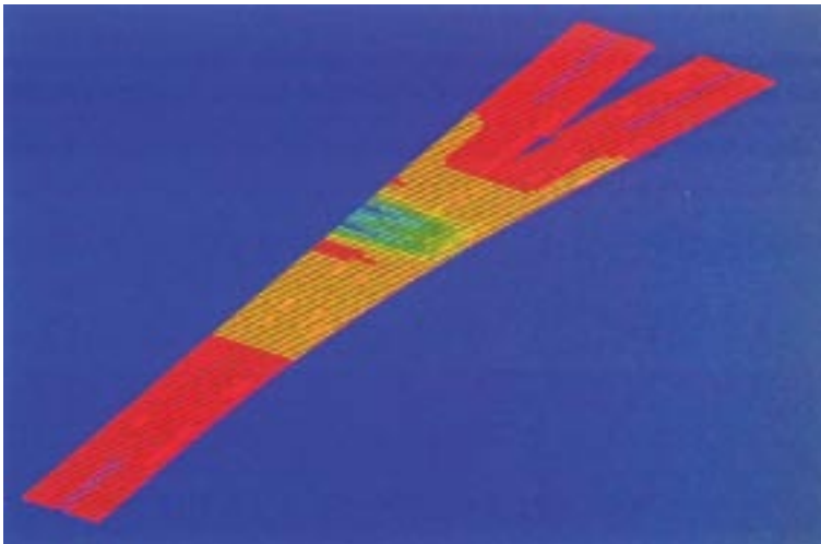
Bild 23: FE-Modell für Dimensionierung der gleichmäßigen Einsenkung bei Weichen
