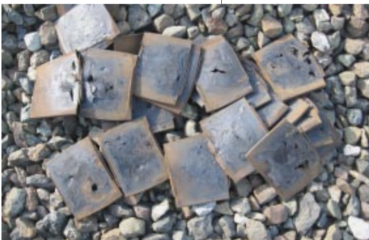
Bild 7: Ausgebaute verschlissene Zwischenlagen von Betonschwellen-Gleisen
