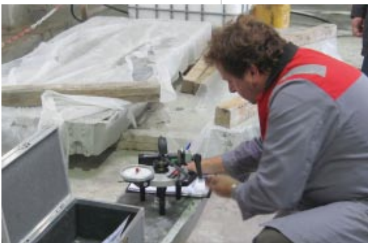
Bild 14: Bestimmung der Abreißfestigkeit an einem kreisförmigen Teil der Besohlung mit d=50 \text{ mm}
